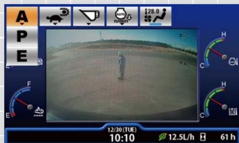
各モードの切り換えは画面上部のタッチスイッチで行う。プルダウンメニュー方式を採用し、全てのモードを一度に確認できる。
