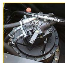
強化型旋回モータ・減速機給油パイプ追加
