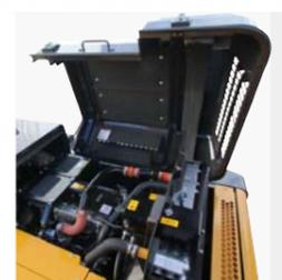
排出ガス後処理システム(SCR)によりNOxを大幅に削減。排出ガスをクリーンにします。
