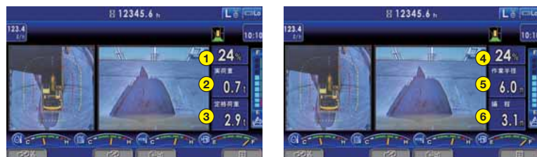
① 負荷率表示 ② 実荷重 ③ 定格荷重 ④ 負荷率表示 ⑤ 作業半径 ⑥ 揚程
