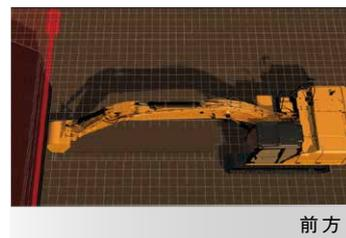
E-フェンスは、「高さ」「深さ」「前方」「キャブ(干渉防止)」「旋回」の作業範囲を制限し、制限範囲に近づくと自動静止します
