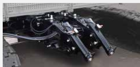
装着状態で作業やリトラクトが可能な折畳式ジャッキ OPTION
