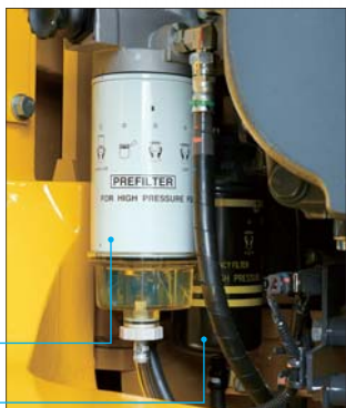
ウォータセパレータ機能付 燃料プレフィルタ 高効率燃料フィルタ
