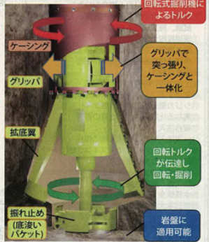
掘削機概要図
