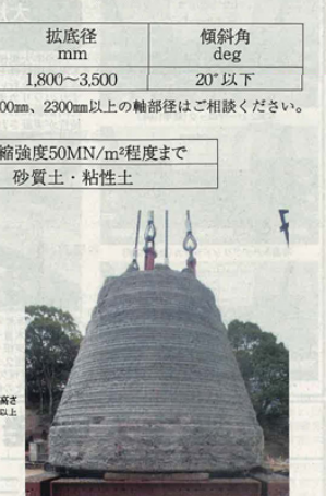
掘出し杭拡底部 φ1.8m/3.5m 施工試験を頁岩・砂岩・地盤で実施 (※一軸圧縮強度60MN/m 2 )
