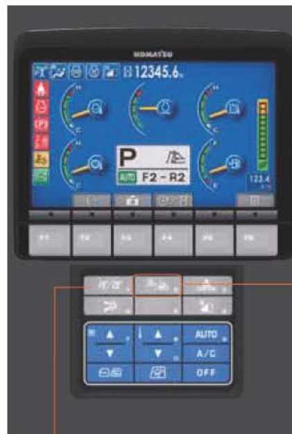
運転モード切り換えスイッチ
