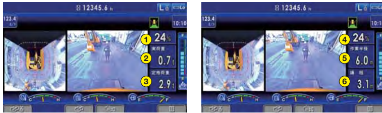
① 負荷率表示 ② 実荷重 ③ 定格荷重 ④ 負荷率表示 ⑤ 作業半径 ⑥ 揚程 ※用途に応じて画面表示の切り換えが可能です。
