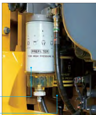
ウォータセパレータ機能付 燃料プレフィルタ 高効率燃料フィルタ
